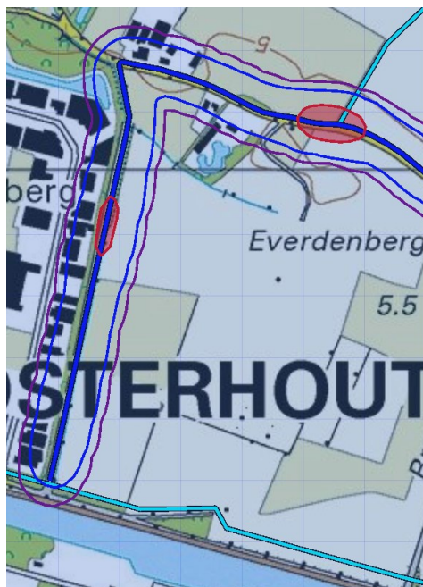
Figuur B1.4: PR 10^{-6} - (rood gearceerd), PR 10^{-7} - (blauw) en 10^{-8} -contour (paars) van leiding Z-521-01
