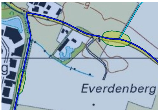
Figuur 3.2: PR 10^{-6} -contour van leiding Z-521-01 (geel gearceerd)
