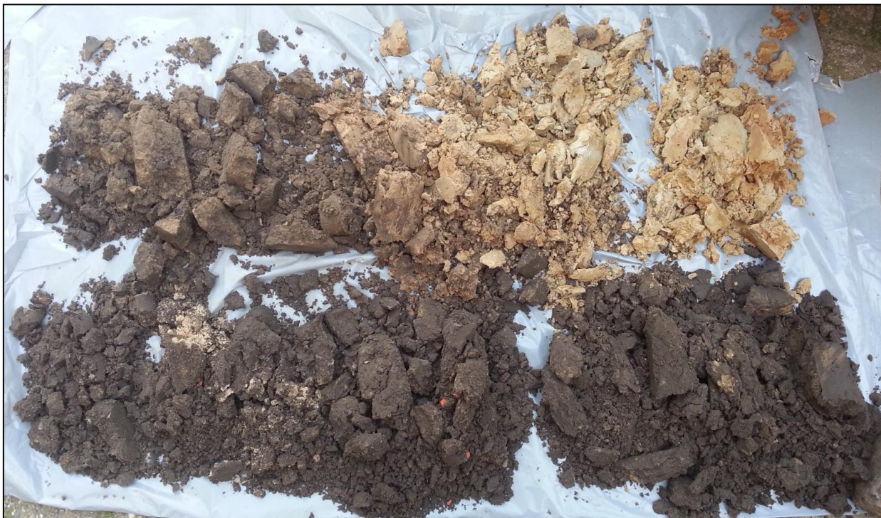
Figuur 6: Het boorprofiel van boring 1. De leesrichting is van linksonder naar rechtsboven (0-180 cm –mv).
