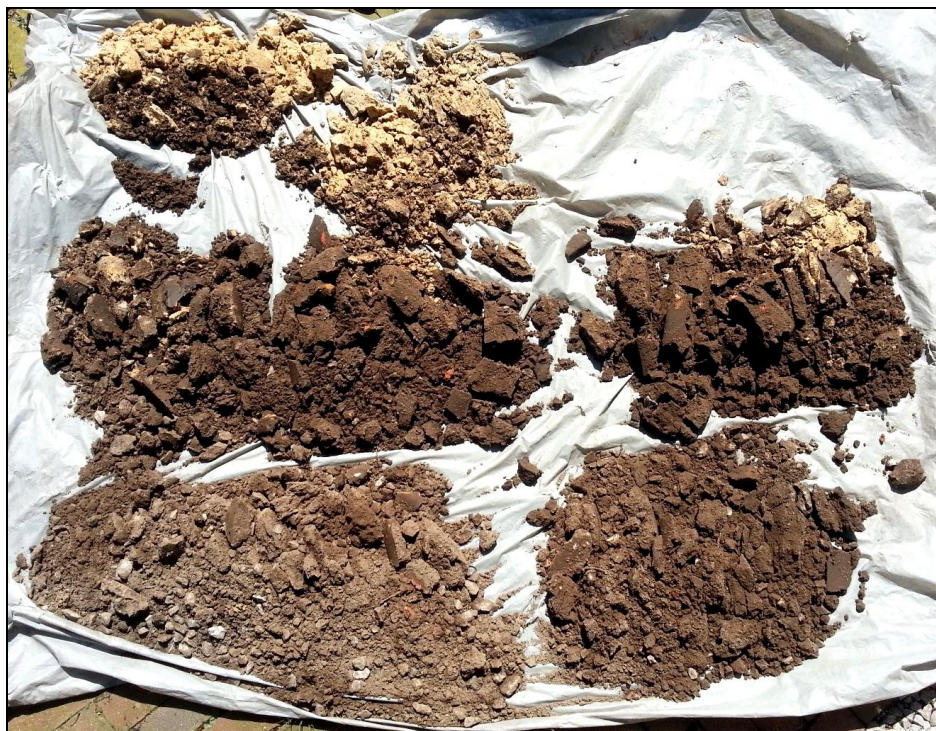
Figuur 9: Het boorprofiel van boring 6 uitgelegd van linksonder naar rechtsboven (0 – 230 cm –mv).
