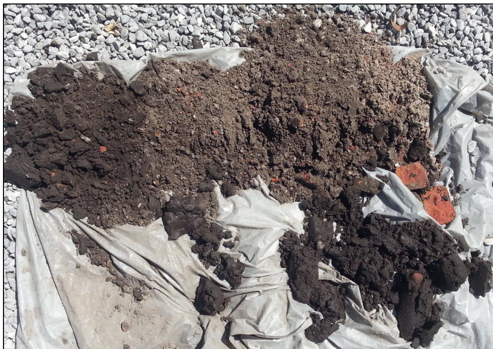
Figuur 8a: Het boorprofiel van boring 2 tot 250 cm -mv. De leesrichting is van rechtsboven naar linksonder.
