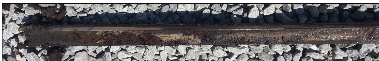
Figuur 8c: Het boorprofiel van boring 2 (guts), detail van onderzijde profiel.
