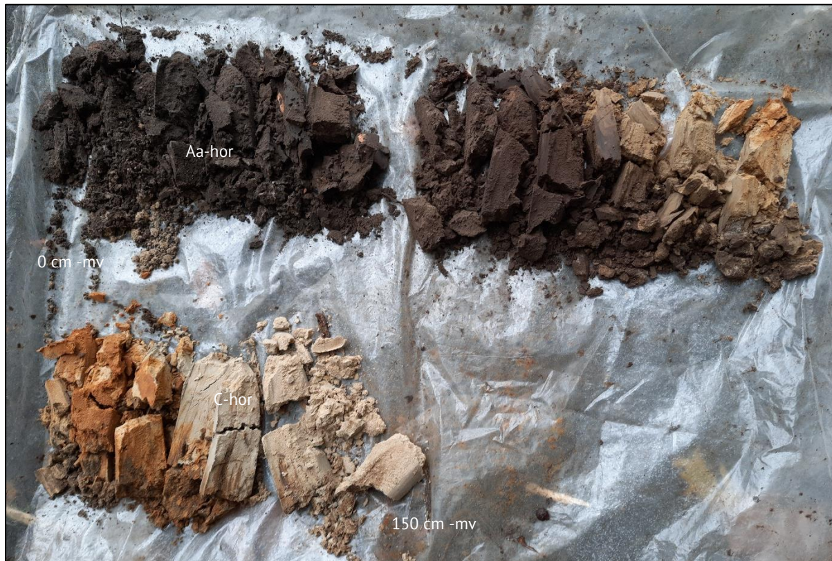
Figuur 10. Foto boorprofiel van boring 6. De leesrichting is van linksboven naar rechtsonder (0 – 150 centimeter).
