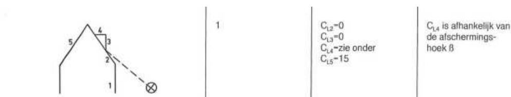
Figuur 2.1 CI-correctie voor de geluidniveauverdeling over het geveloppervlak
