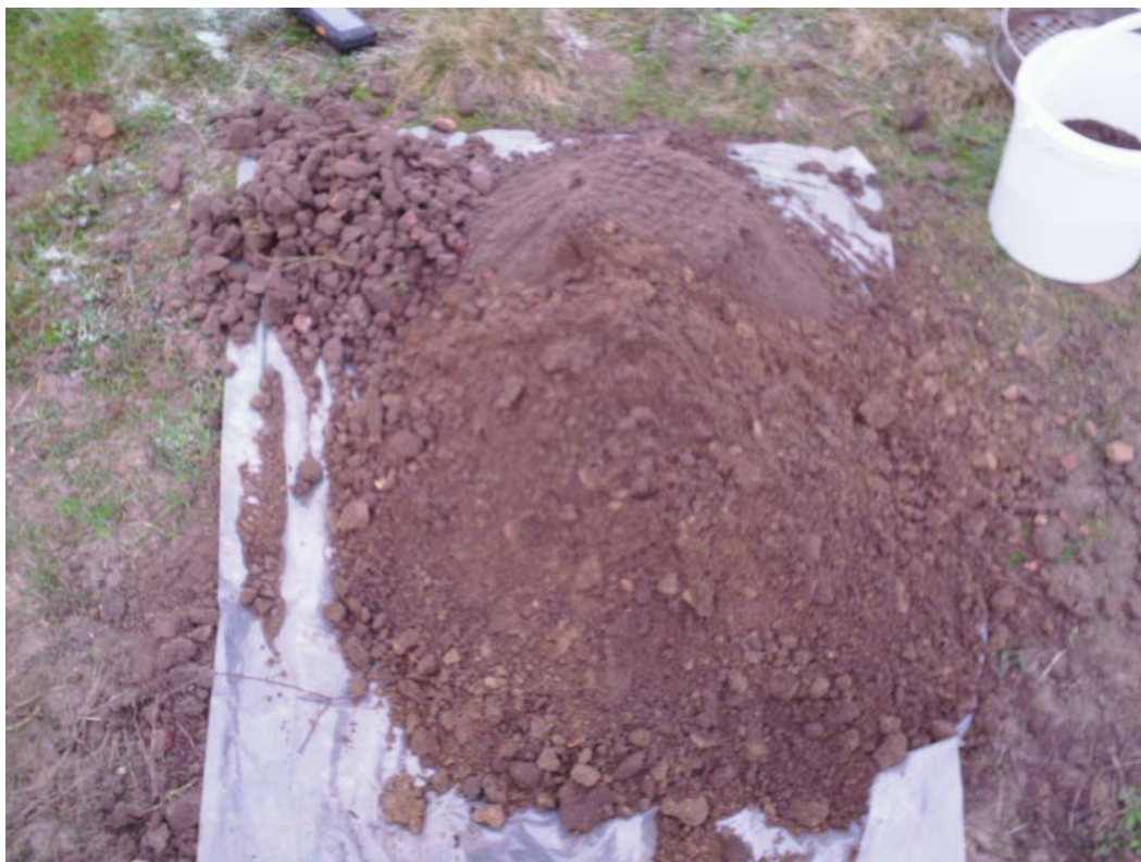
Foto 9 (Zeeffractie en ondergrond gat 3)
