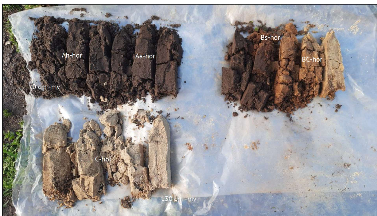
Figuur 6: Foto van boorprofiel 3. Leesrichting is van linksboven naar rechtsonder (0 – 130 centimeter): matig humeuze donker bruingrijze A-horizont, bruine B-horizont die geleidelijk via de BC-horizont over gaat naar de witbeige kleur (C-horizont).
