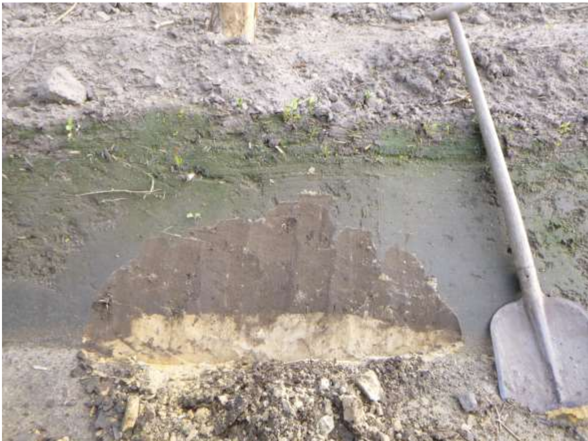
Figuur 23: Foto van het slootprofiel met bovenin de bouwvoor, onderin de C-horizont en daartussen een menglaag of AC-horizont.
