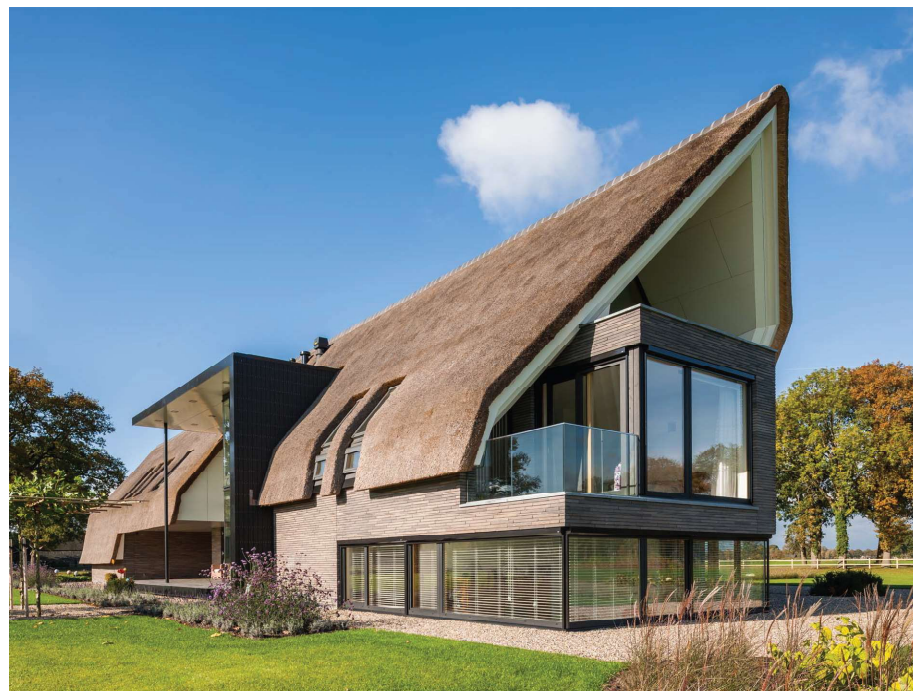
Afwijkende goothoogte voor aanbrengen hirarchie
