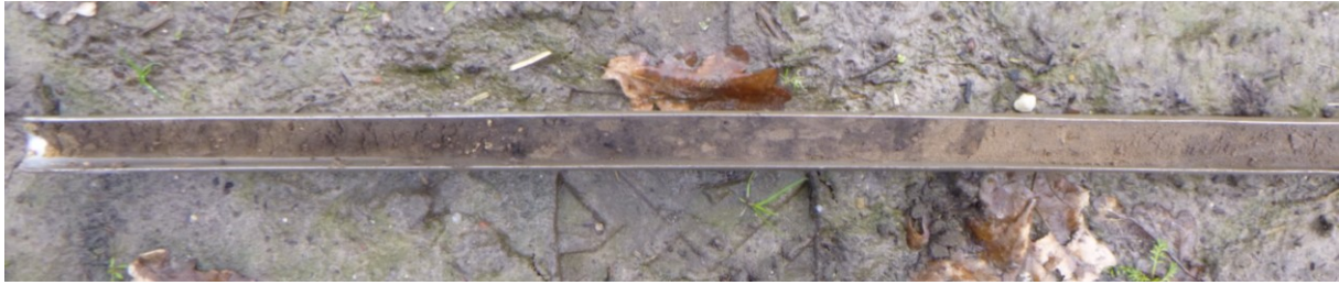
Figuur 4: Het op alle boorpunten aangetroffen pakket vergraven zand dat bestaat uit brokken zand van uiteenlopend humusgehalte.
