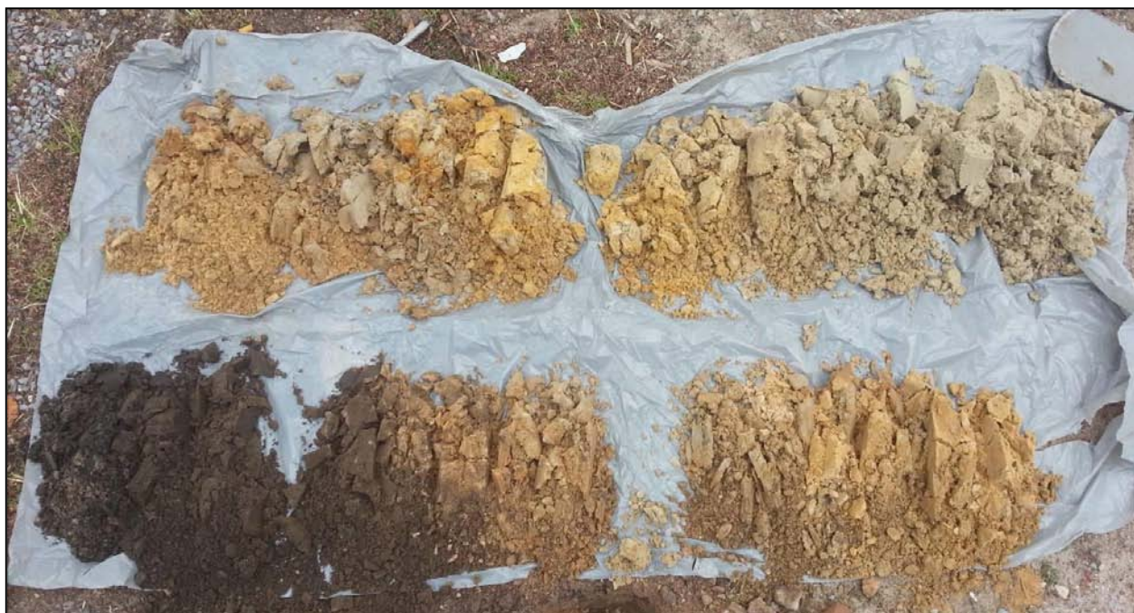
Figuur 8: Het boorprofiel van boring 1 tot 200 cm -mv. De leesrichting is van linksonder naar rechtsboven.
