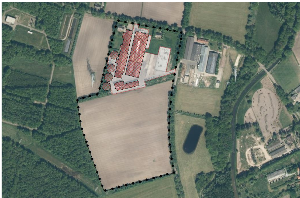
Figuur 8: Te slopen bedrijfsbebouwing is weergegeven in rood. De te behouden bebouwing Broekstraat 30 en 31 -aan de straat- is weergegeven in donkergrijs. Met lichtgrijs is de te verwijderen verhardingen inclusief de bouwwerken zoals sleufsilos en mestbassins ingetekend.
