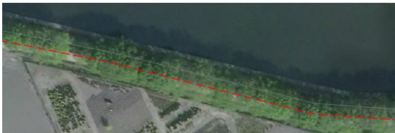
Figuur 5.6 risicoafstand 5 meter buisleidingen
