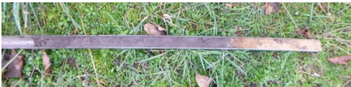
Figuur 26: Foto van de BC-horizont (rechts van het humusrijke zand), die in boring 2 is aangetroffen.
