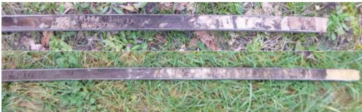
Figuren 24a en 24b: Het sterk vergraven zandpakket zoals deze op zeven van de acht boorpunten is aangetroffen.
