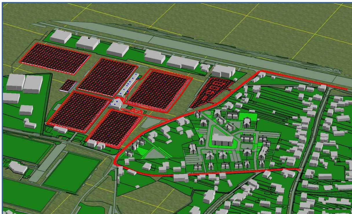
Afbeelding 5. Rekenmodel, 3d-weergave met oppervlaktebronnen
