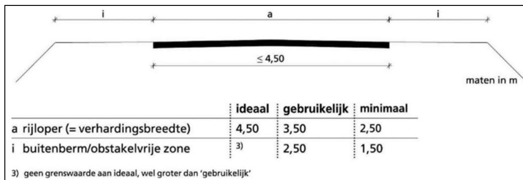
Figuur 4-8 Voorkeursprofiel erftoegangsweg type II
