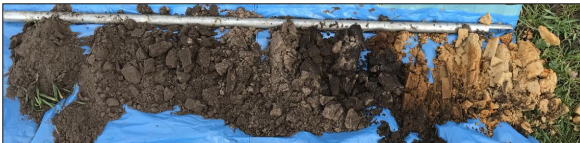
Figuur 5: Zicht op boring 5, uitgelegd van links naar rechts (0-120 cm -mv).
