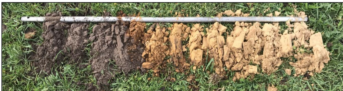
Figuur 4: Zicht op boring 1, uitgelegd van links naar rechts (0-100 cm -mv).
