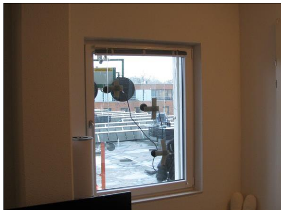
Foto II.2 Aanzicht microfoonposities in spouw
