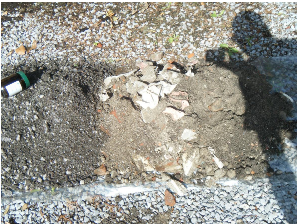
Foto 4. Opgeboord material uit asbestgat 05
