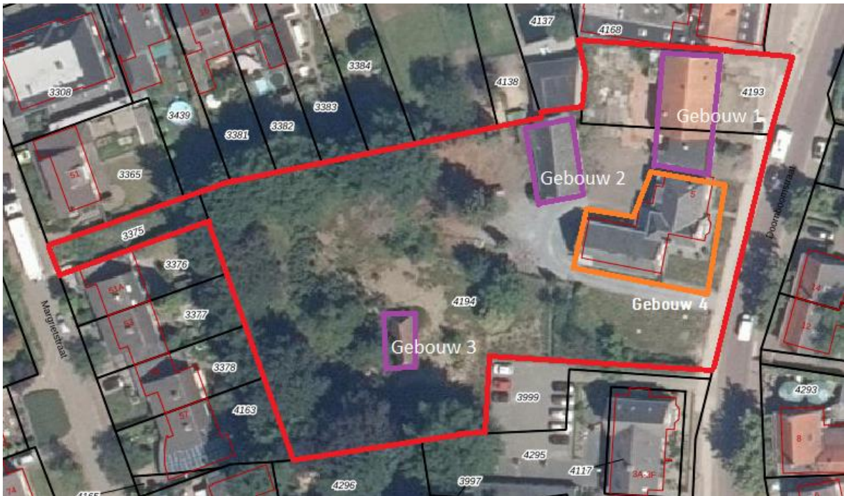
Afbeelding 2: De projectlocatie met te slopen bebouwingen (binnen paars kader) en te verbouwen woning (binnen oranje kader). Bron: Kadviewer, datum: 04-11-2020
