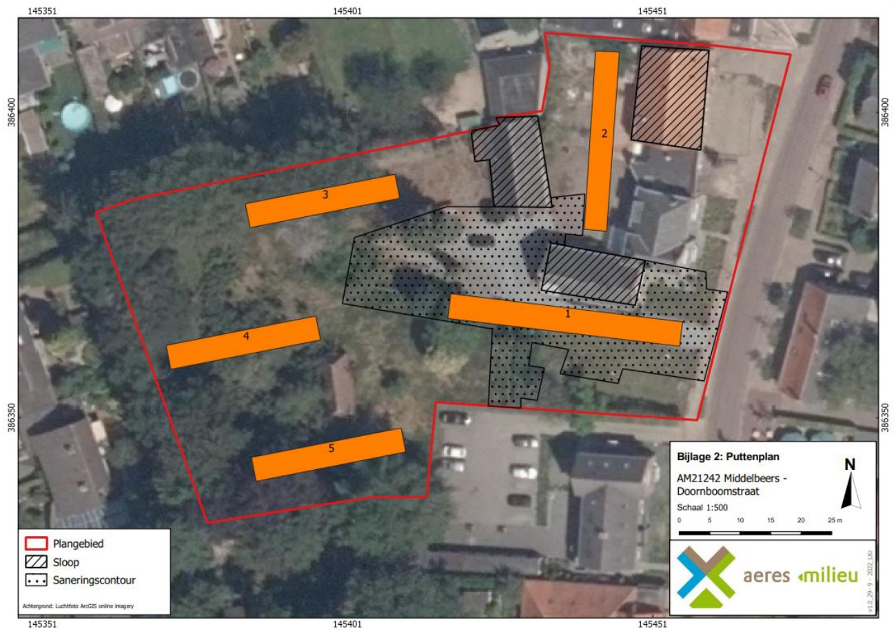
Figuur 3. Puttenplan (oranje) volgens het Programma van Eisen met in strepen arcering de delen die gesloopt gaan worden en in gestippelde arcering de saneringscontour.
