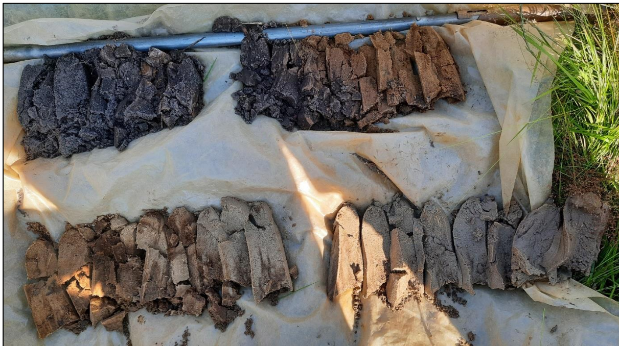
Figuur 16. Boorprofiel boring 4. Leesrichting van linksboven naar rechtsonder (0 -200 centimeter).
