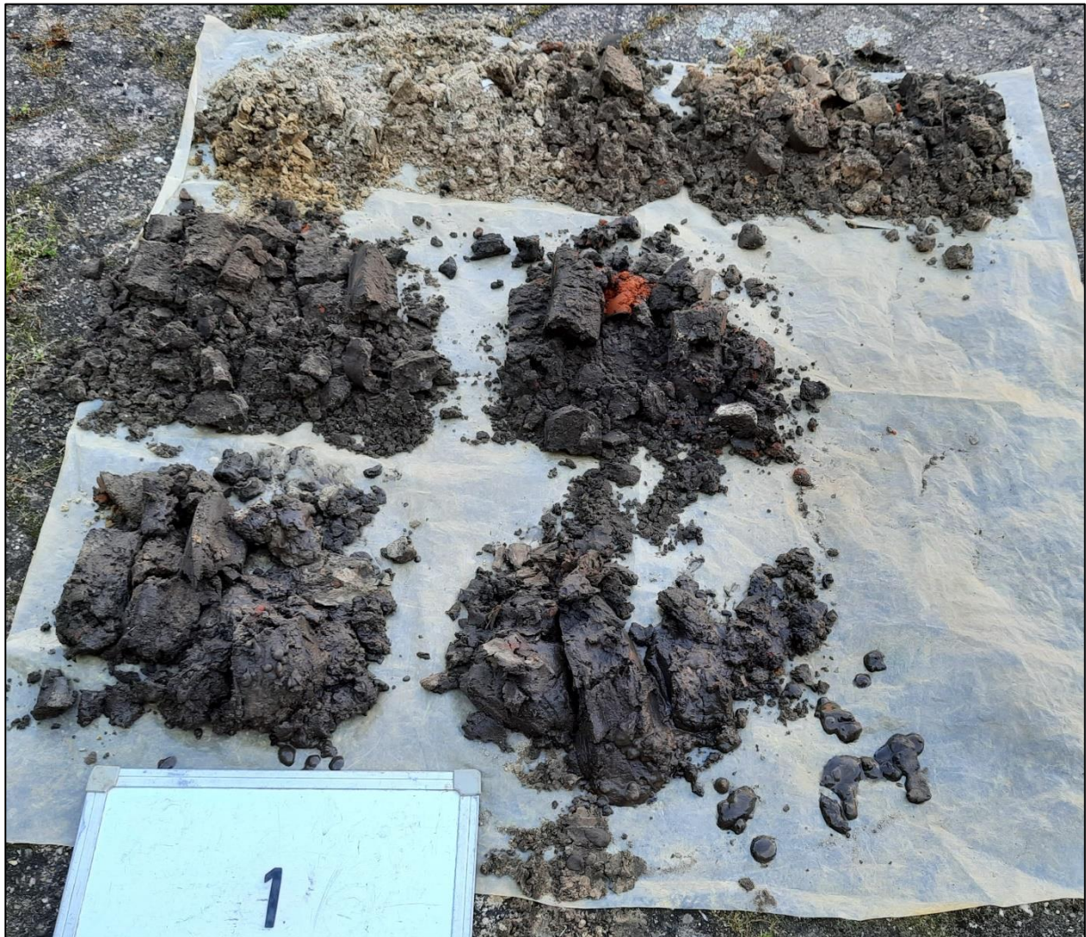
Figuur 18. Boorprofiel boring milieukundig bodemonderzoek. Leesrichting: linksboven naar rechtsonder.
