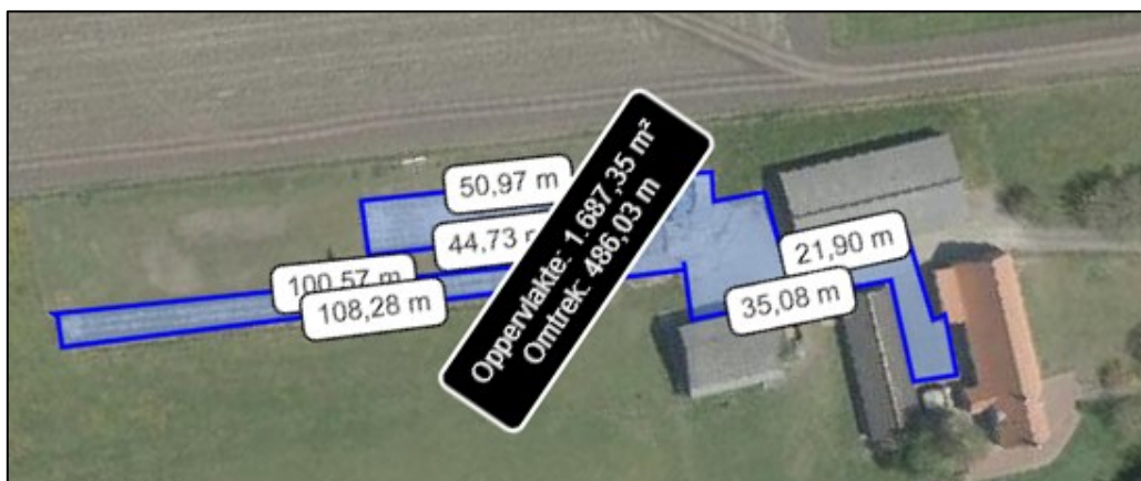
Figuur 5: Overzicht te verwijderen verharding projectlocatie.
