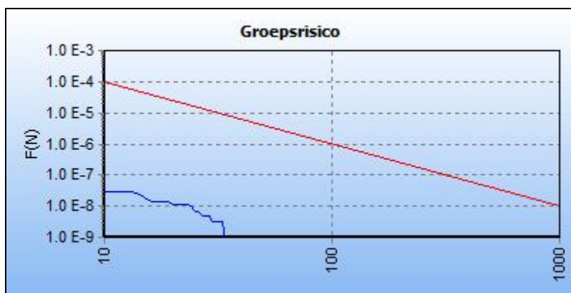
Figuur 17: fN-curve leiding-Z-510-28 (huidige situatie)
