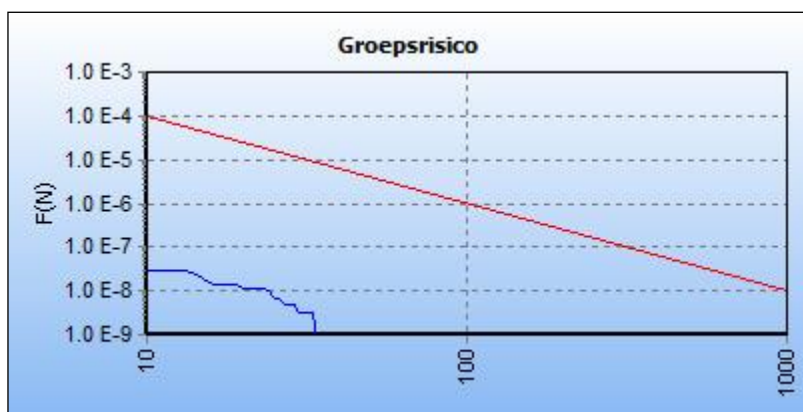
Figuur 18: fN-curve leiding-Z-510-28 (toekomstige situatie)
