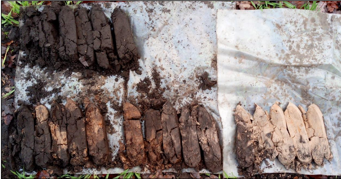
Boring 11. Tussen circa 60 en 160 cm -Mv is een slootvulling te herkennen.
