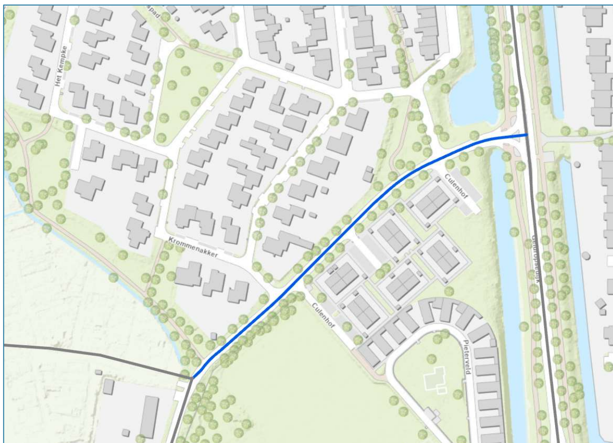
Figuur 3 Aan te brengen SMA-NL8 op de Wettenseind (blauwe lijn)
