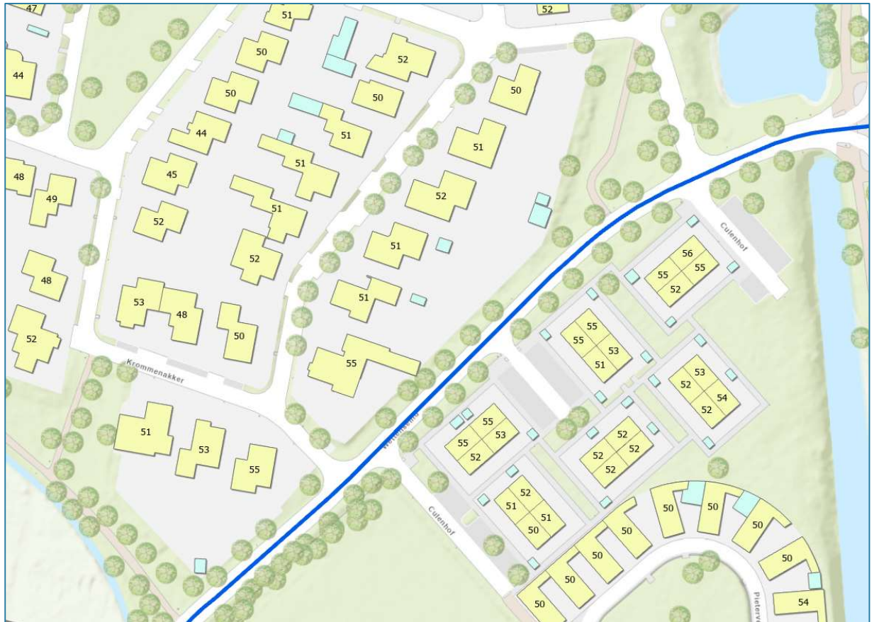
Figuur 2 Maximale geluidbelasting van (gesommeerd) verkeersgeluid na aanbrengen van SMA-NL8 in de plansituatie [dB]
