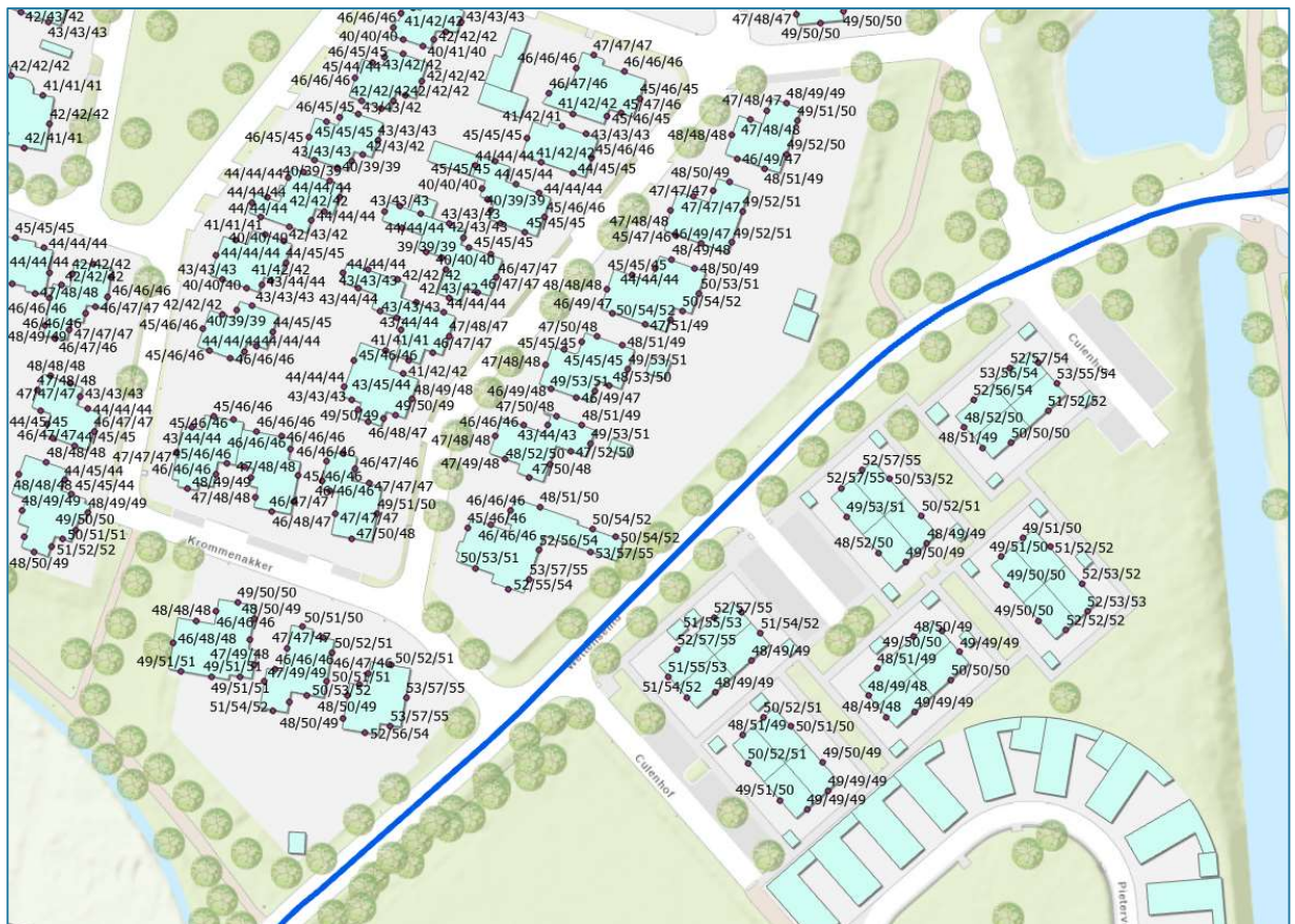
Figuur 1 Geluidbelasting gesommeerd wegverkeer [dB] voor de autonome situatie/plansituatie/plansituatie met SMA-NL8 (blauwe wegvak)
