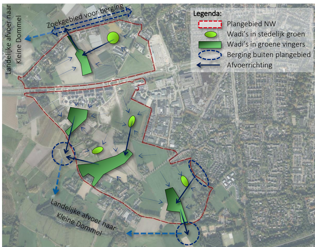
figuur 16. Waterhuishoudkundige principes voor infiltratie, retentie en afvoer in Nuenen West.
