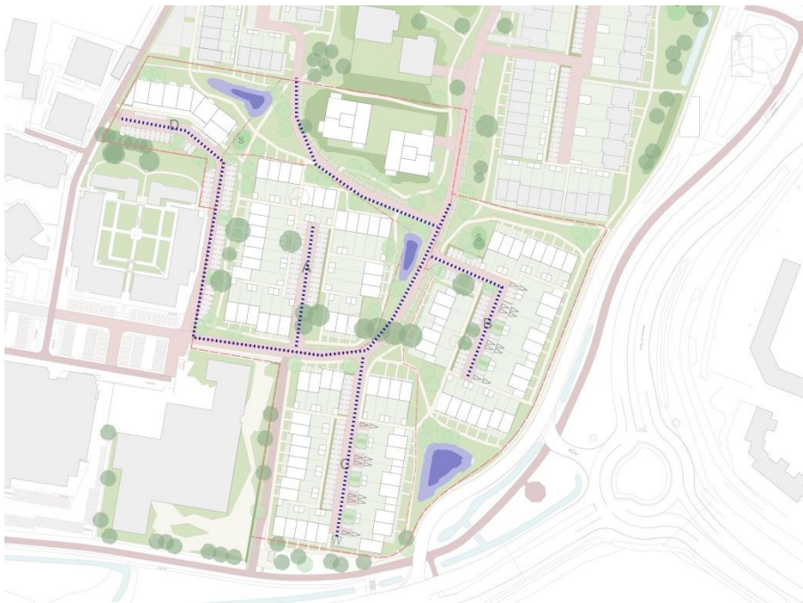
Figuur 4.9: Hemelwatervoorzieningen fase 2 (infiltratieriool en wadi's)
