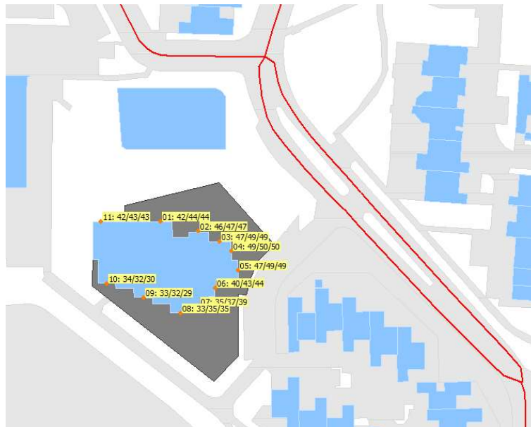
Figuur 3: Geluidbelasting in dB per bouwlaag ten gevolge van de Brabantring.
