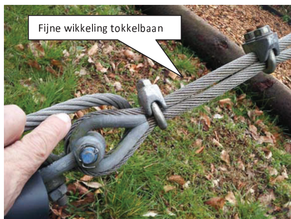
Afbeelding 6.4: geleider tokkelbaan met fijne wikkeling
