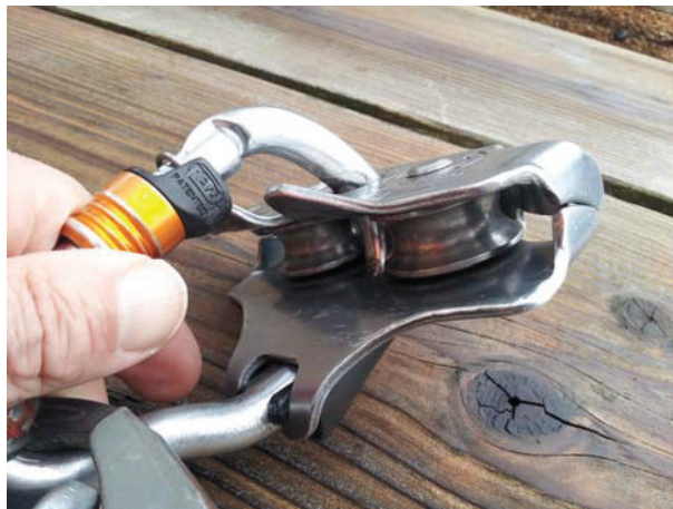
Afbeelding 6.2: geleider tokkelbaan asgelagerd
