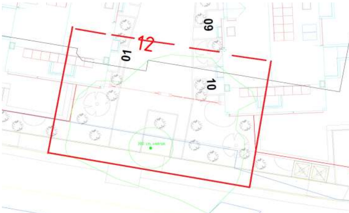
Figuur 42: De volledige boombescherming met een rode lijn weergegeven. De rode stippellijn betreft de bouwhekken die niet direct geplaatst kunnen worden. Dit zal plaatsvinden nadat het huidige pand is gesloopt. Daarvoor worden de bouwhekken tot aan de gevel van het pand geplaatst.
