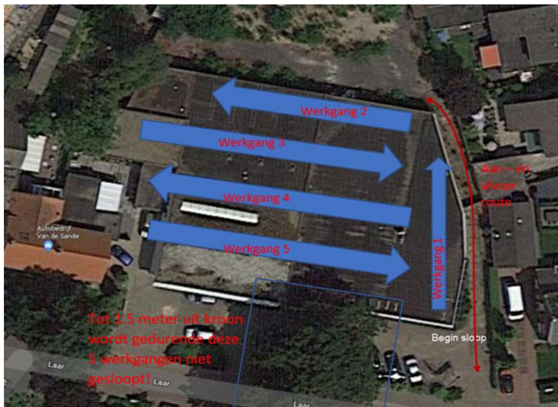
Figuur 14: De werkwijze gedurende het slopen van het pand.
