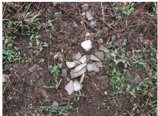
Foto asbestverdacht plaatmateriaal nabij ABG01
