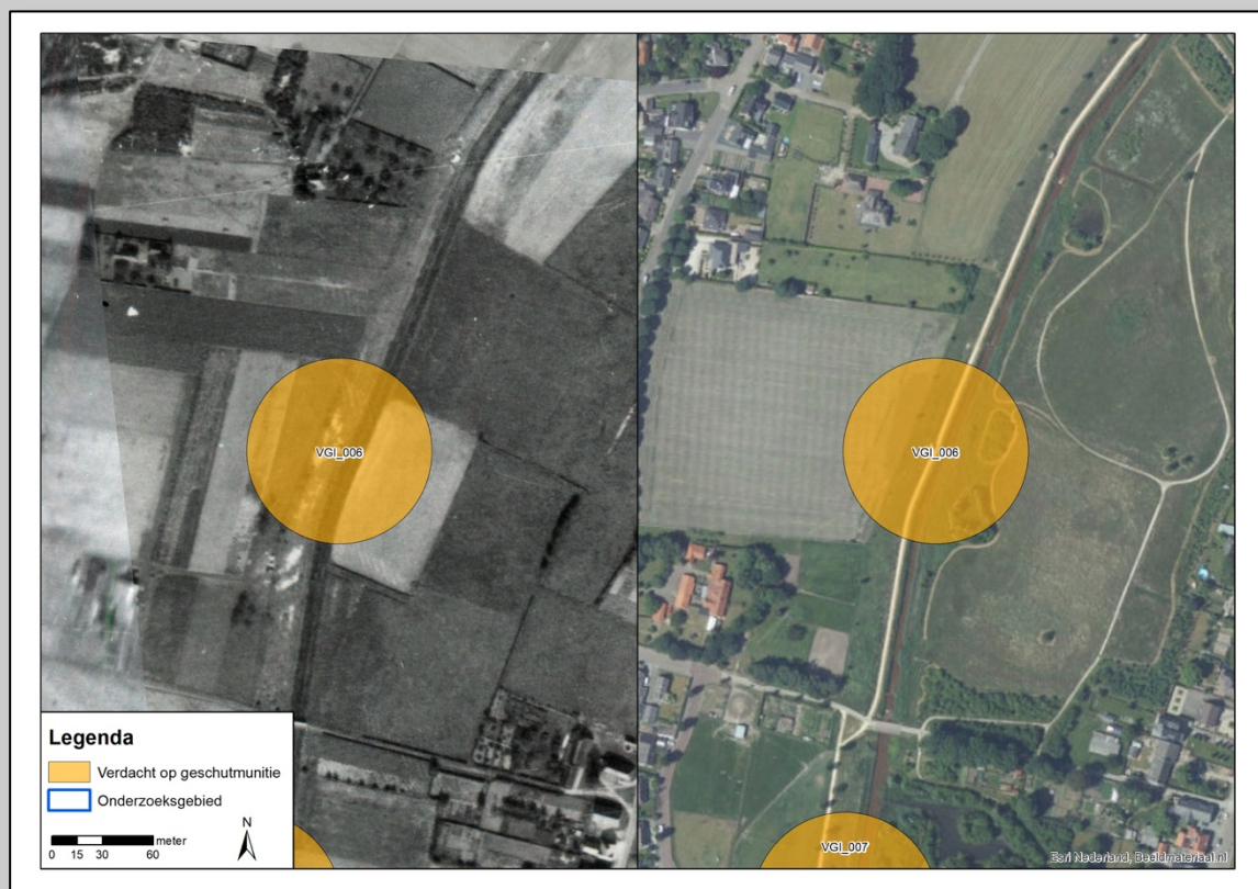
Afbeelding 37: Naoorlogse ontwikkelingen verdacht gebied VGI_006. Door het verdachte gebied is een weg aangelegd of is een bestaande weg verbreed. Het is niet bekend tot welke diepte de bodem is geroerd.
