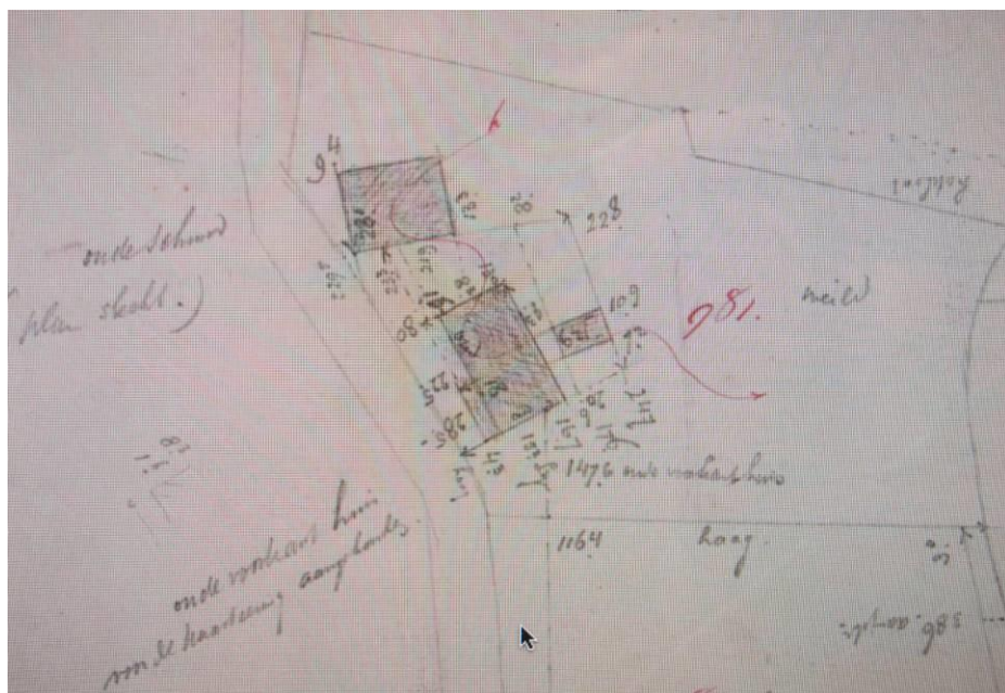
Kadastraal veldwerk uit 1898, waarop te zien is dat de schuur wordt vernieuwd en de boerderij wordt vergroot. Bron: Kadaster.
