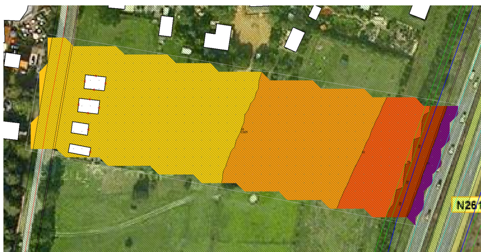
Figuur C2. Contouren geluidbelasting ten gevolge van verkeer op de N261, ( L_{den} inclusief aftrek ex artikel 110g Wgh) – Groen: 0-48 dB, geel: 48-53 dB, donker geel: 53-58 dB en oranje: 58-63 dB.
