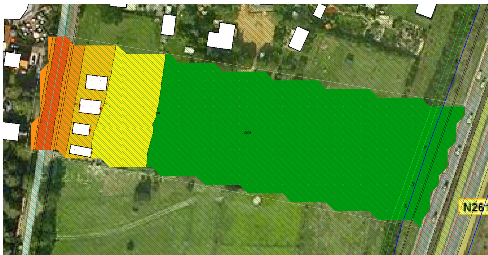
Figuur C1. Contouren geluidbelasting ten gevolge van verkeer op de Horst ( L_{den} inclusief aftrek ex artikel 110g Wgh) – Groen: 0-48 dB, geel: 48-53 dB en donker geel: 53-58 dB.
