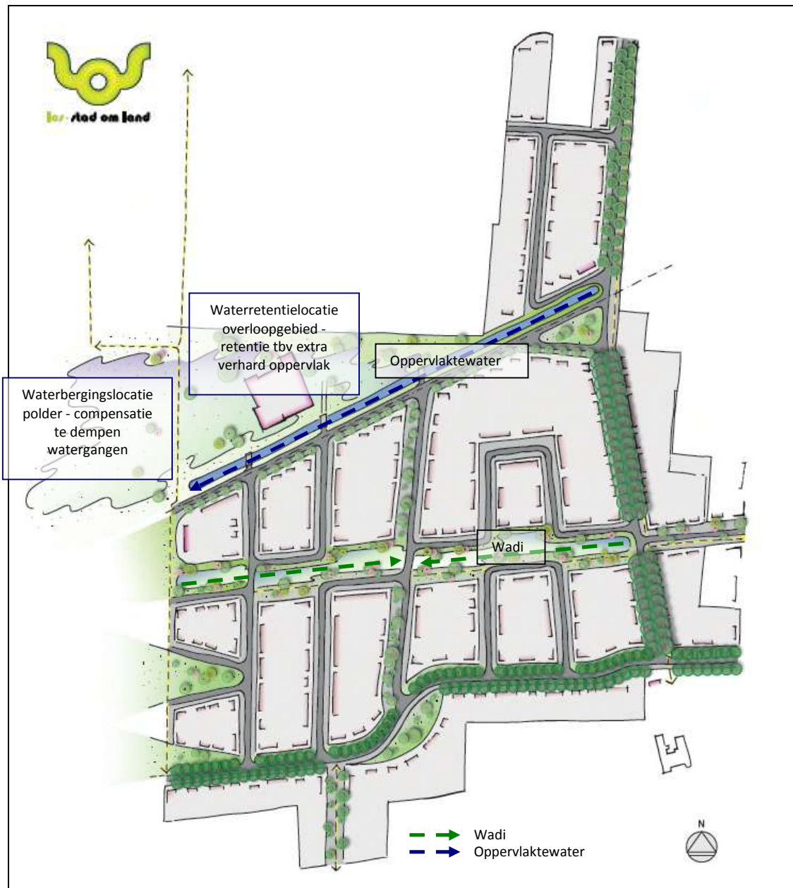
Figuur 4.2 schetsmatige weergave principe watersysteem Sweetsstraat-West
