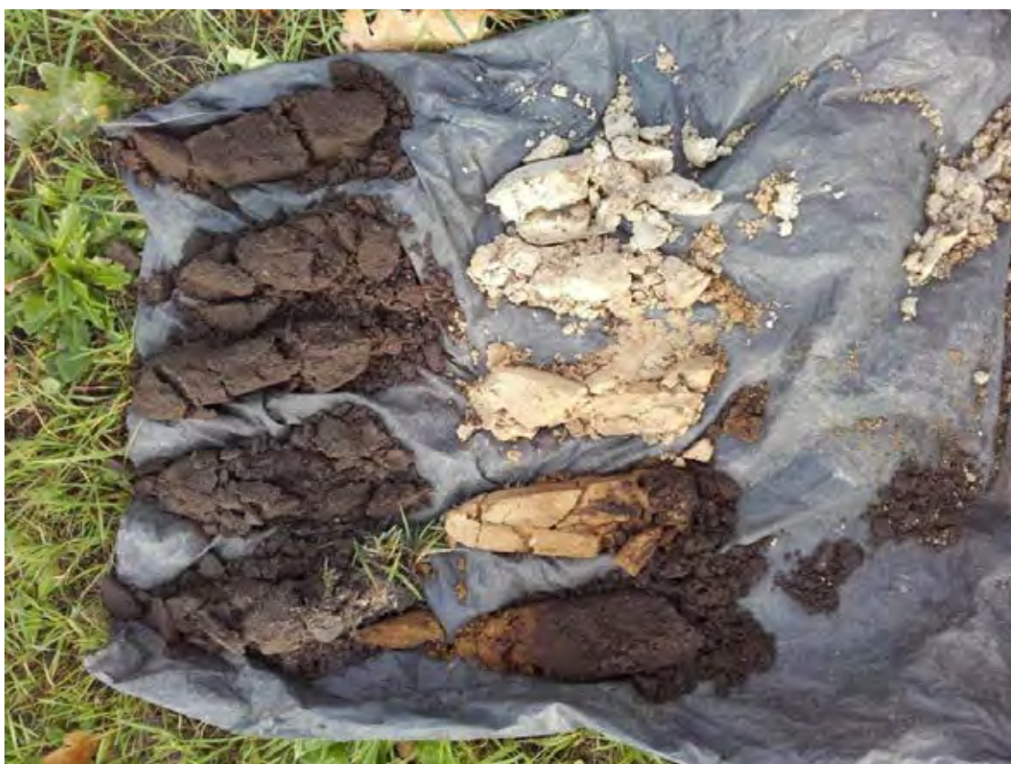
Afbeelding 9 Boring 3666005 met een geleidelijke overgang van een ca. 50 cm dikke humeuze bovengrond via een restant van een ca. 10 cm dikke podzol-B horizont via gelig dekzand naar grijze leem. Bron: foto Vestigia (01-11-2017).
