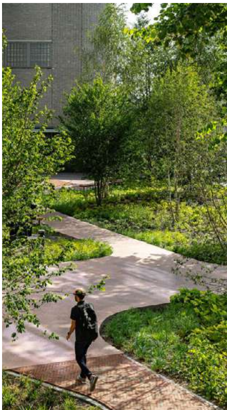
Verlaagde plantvakken voor lokale infiltratie.
