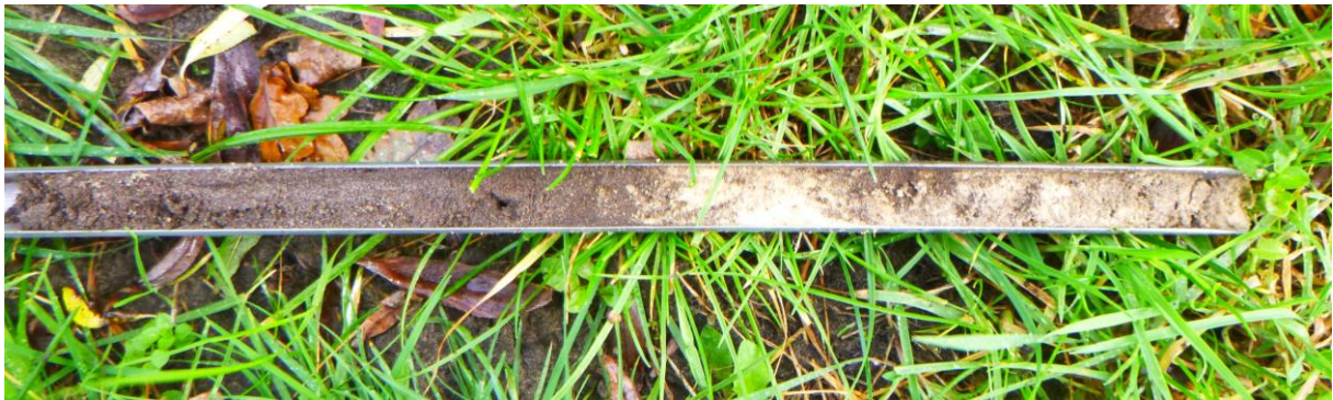
Figuur 23: Foto van het gele zand met daarin brokken humeus zand (rechts van het midden), zoals dit op de boorpunten 5, 8, 9, 12, 17, 18, 21, 22, 23, 26 en 28 is aangetroffen.
