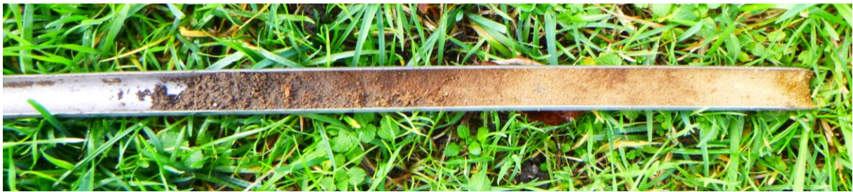
Figuur 24: Foto van het restant van een BC-horizont (rechts van het midden) zoals in de boringen 13, 16 en 25 is aangetroffen onder de toplaag.
