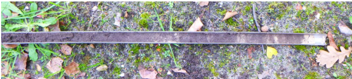
Figuur 22: Foto van humusrijke zand met daarin brokken geel zand zoals dit op de boorpunten 10, 11, 20 en 27 is aangetroffen.
