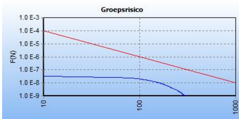
5.1 Figuur 5.1 FN curve voor 5801-LOZ1-10-S 2010-08-20 LoZ LeidingData rev 01 van Alliander voor de kilometer tussen stationing 1140.00 en stationing 2140.00
