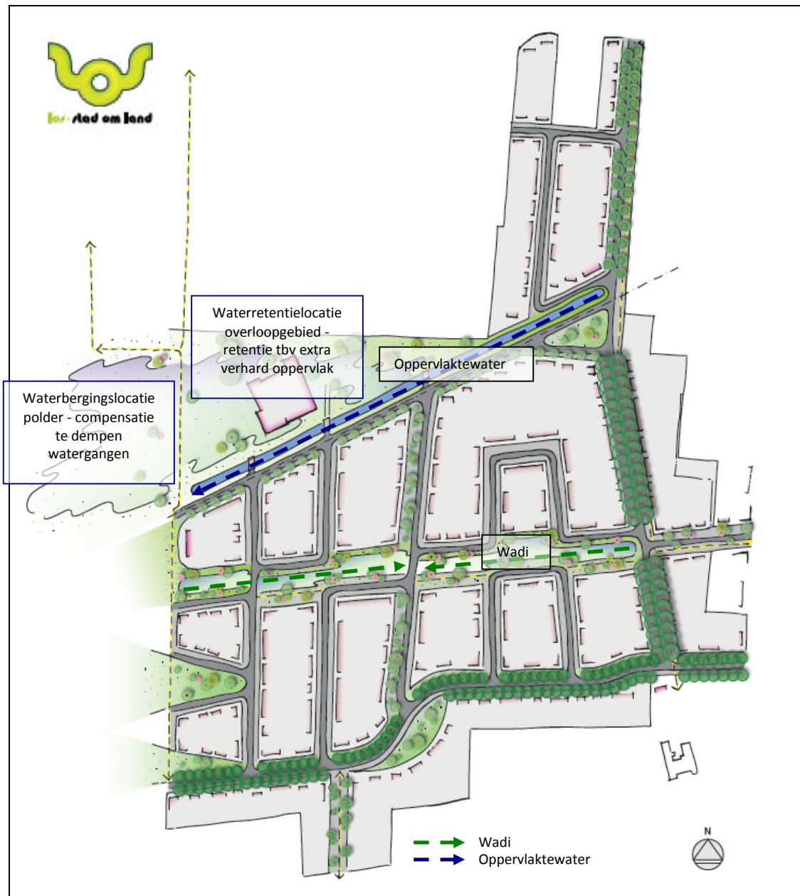
Figuur 4.2 schetsmatige weergave principe watersysteem Sweetsstraat-West
