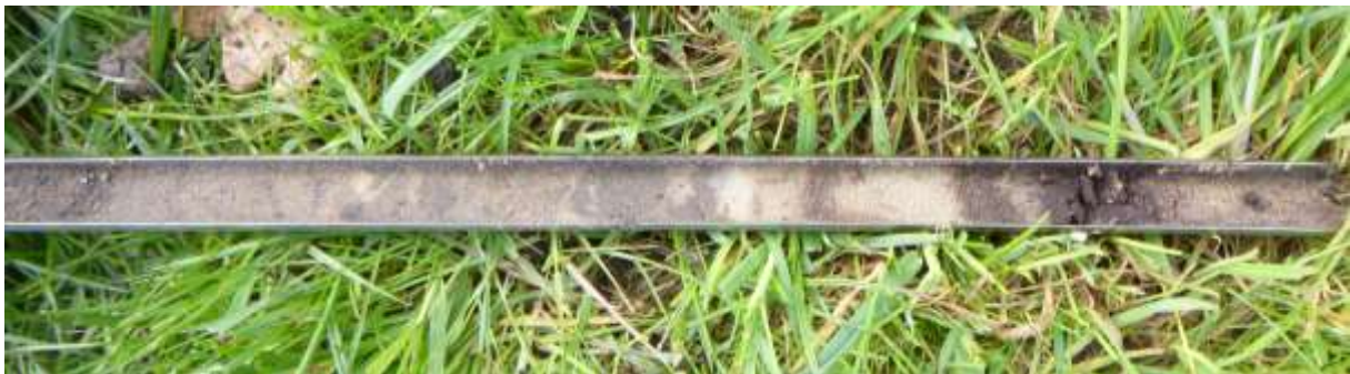
Figuur 21: Foto van de laagjes sterk veraard veen (rechts) die zijn aangetroffen in de het schone geelgrijze dekzand onder het pakket vergraven zand (links).
