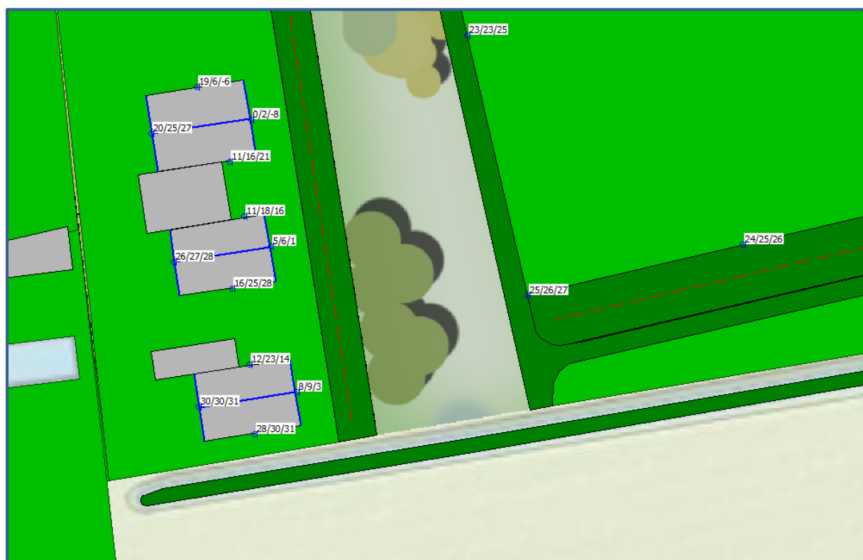
Afbeelding 5. Geluidbelastingen L_{den} (incl. aftrek art. 110g Wgh) Bolakker Berekende geluidbelastingen op een hoogte van 1,5 / 4,5 / 7,5 meter
