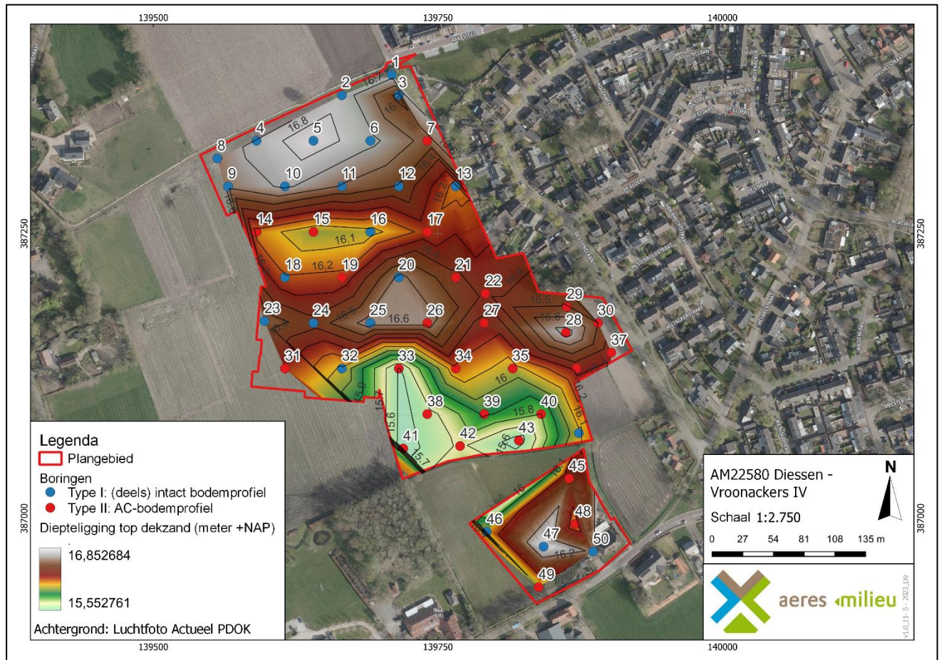
Figuur 15. De hoogteligging van de natuurlijke ondergrond (dekzand), weergegeven in meter +NAP.
