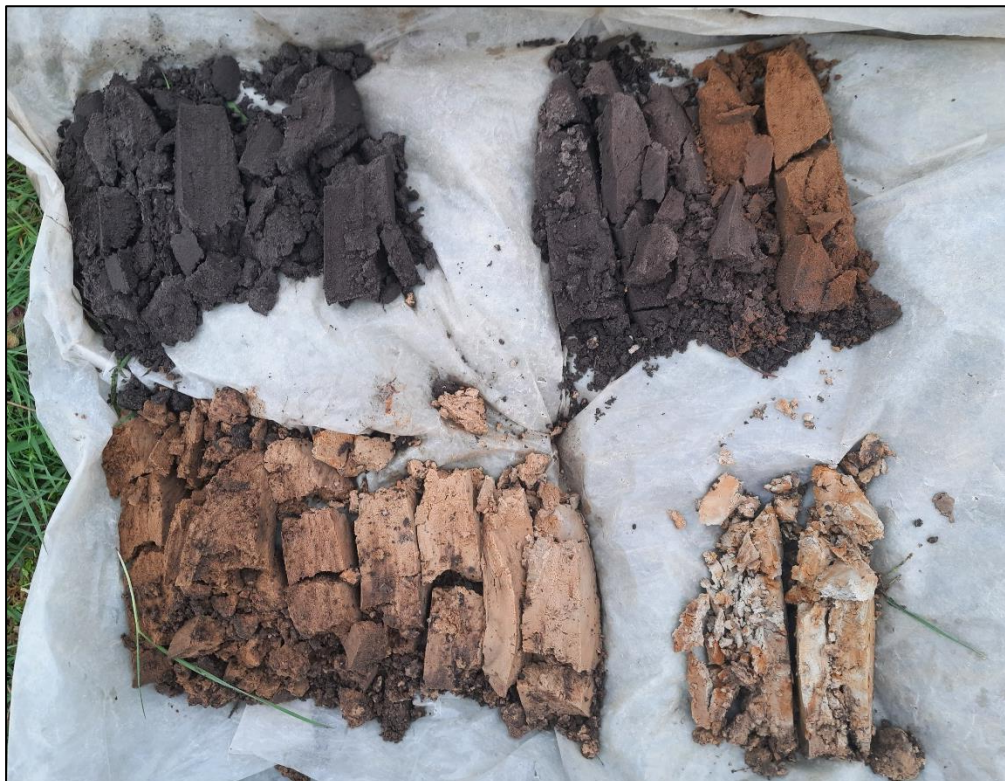
Figuur 13. Foto van boring 1, type I boring. De leesrichting is van linksboven naar rechtsonder (0 – 170 centimeter) (Foto: 29 maart 2023).
