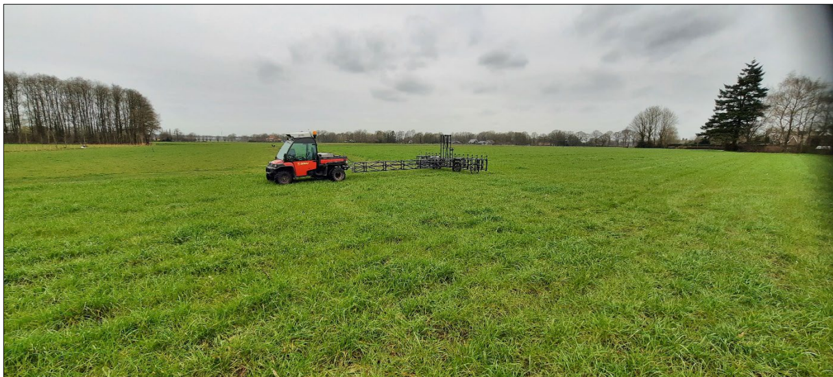
Figuur 2. Uitvoeren passieve non realtime oppervlakedetectie.
