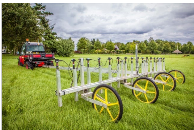
Figuur 14. Passieve non realtime oppervlakedetectie met het Vallon Multisondesysteem VXV16 en een staafdiagram waarop het maximale detectiebereik (m² – maaiveld) per kaliber is weergegeven.
