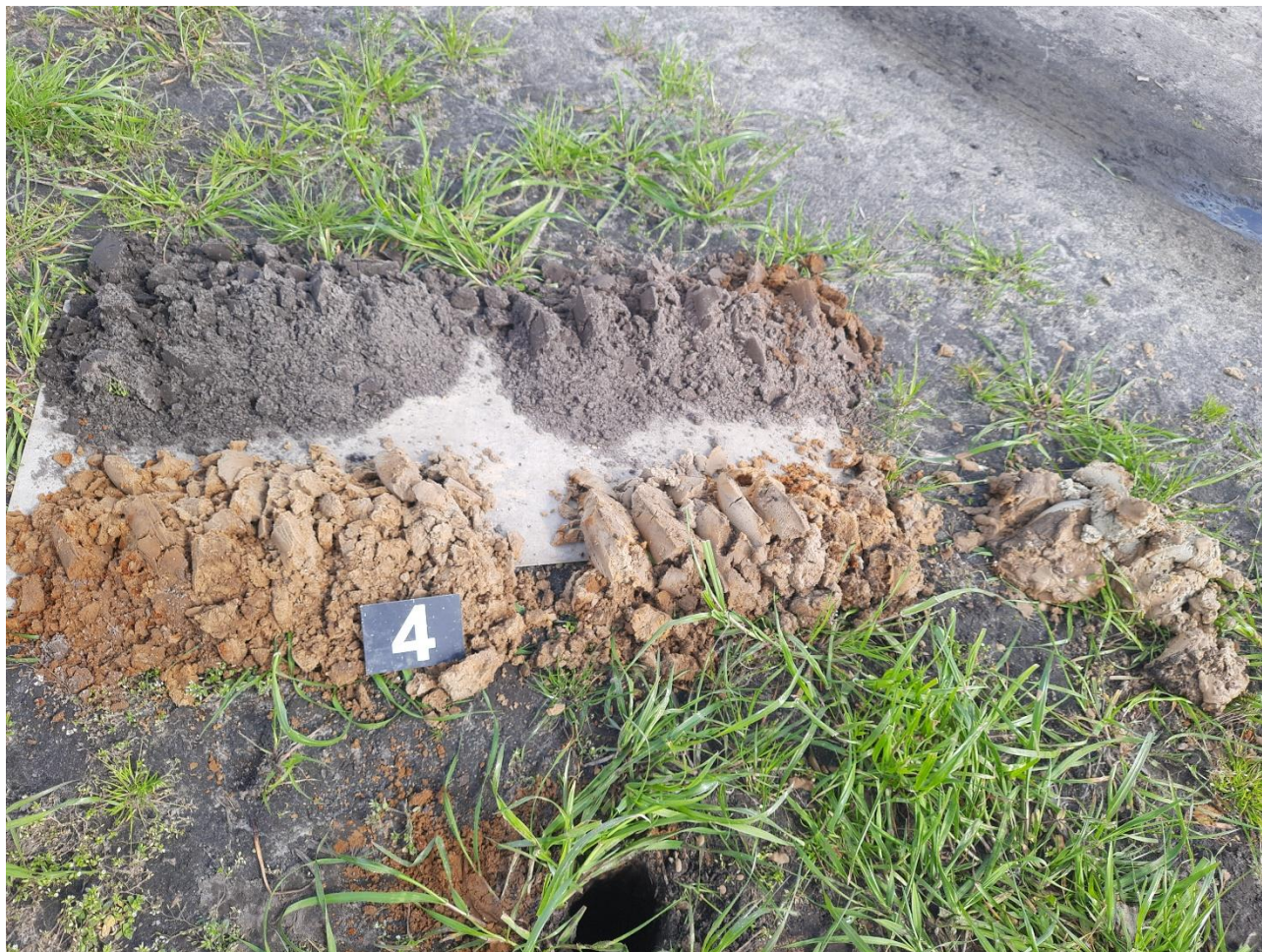
Afbeelding 8: Foto profielboring uitgelegd per meter vanaf maaiveld (linksboven) tot einddiepte (rechtsonder).
