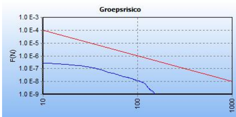
5.2 Figuur 5.2 FN curve voor 5238_leiding-A-525-deel-1 van N.V. Nederlandse Gasunie voor de kilometer tussen stationing 1600.00 en stationing 2600.00
