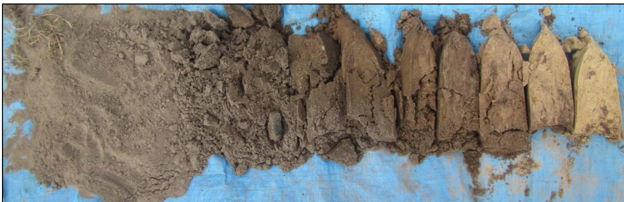
Figuur 6: Profiel van boring 5. De leesrichting is van links naar rechts.
