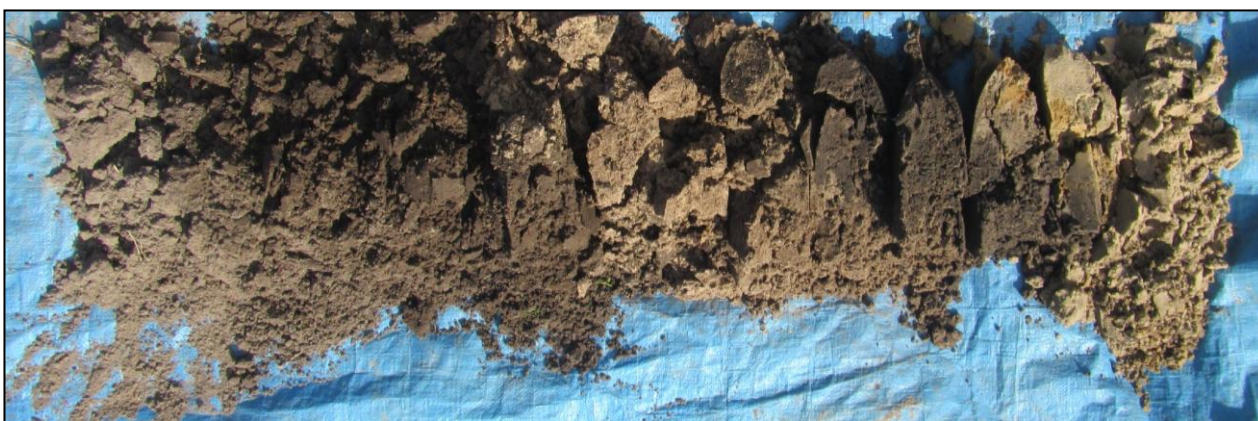
Figuur 7: Profiel van boring 4. De leesrichting is van links naar rechts. De rechter helft van het boorprofiel toont een volledig omgezette bodem.
