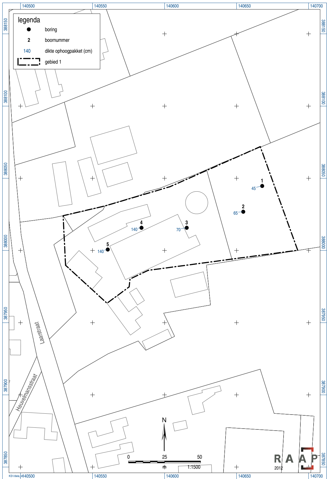
Figuur 10. Resultaten booronderzoek.
