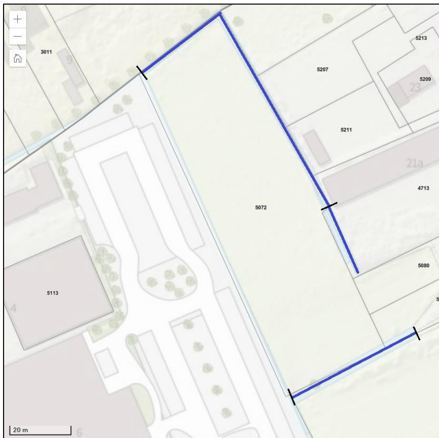
Figuur te dempen greppels – tussen de twee zwarte markeringen in wordt de greppel gedempt.
